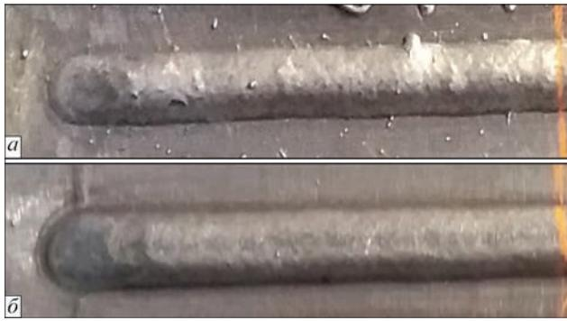
Рис. 2. Внешний вид наплавленного валика: *a* — стационарный режим сварки,  $I_{св} = 160$  А,  $U = 24$  В; *б* — импульсный режим сварки,  $I_{ср} = 160$  А,  $U = 24$  В, скорость сварки в обоих случаях 15 м/ч
