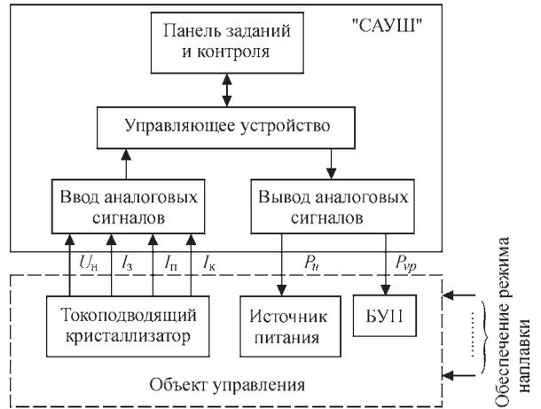
Рис. 5. Структурная схема автоматизации проплавлением основного металла при ЭШН в ТПК
