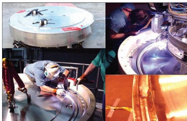
Рис. 4. Приварка крышки контейнера
