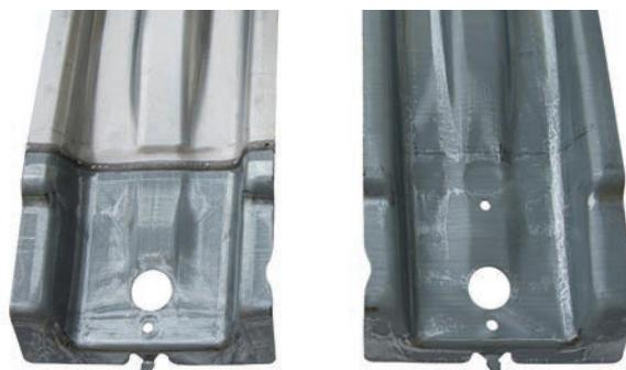
Сварочный процесс Fronius CMT дает возможность надежно и эффективно соединять сталь и алюминий
