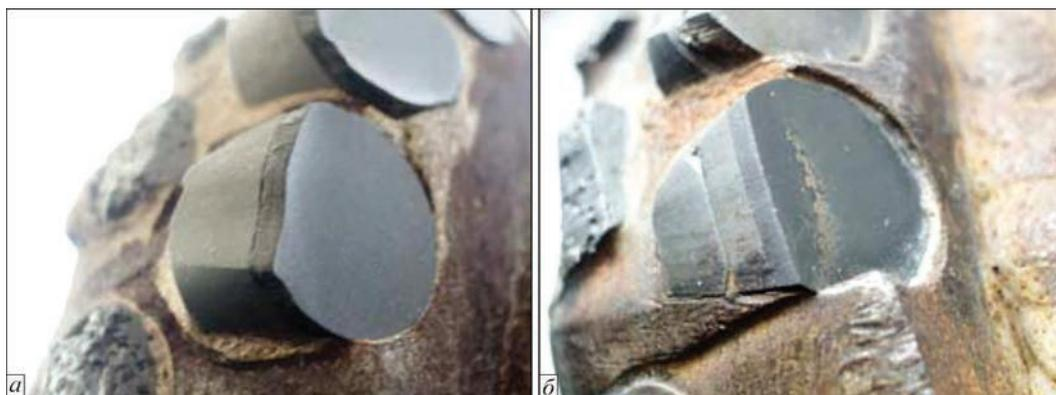
Рис. 1. Внешний вид изношенных резцов лопасти стального бурового долота (×3): а — ATP «Syndrill» после проходки 1000 м; б — составной резец ATP ИСМ НАНУ после проходки 250 м
