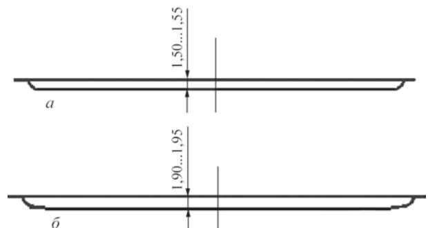
Рис. 2. Граница изотермы  $T_{пл}$  в плоскости, перпендикулярной наплавляемой поверхности (лента 45×0,7 мм): а — наплавка на сталь 25X1M1Ф; б — на подслое из стали 08X17H12M2
