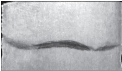
Рис. 3. Форма металлической ванны в наплавляемом металле, образующейся при электрошлаковом переплаве (наплавке) дискретной присадки в ТПК
