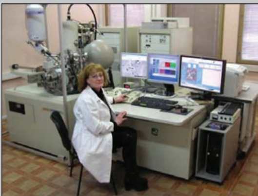
JAMP-9500F (Japan) — электронный сканирующий микроскоп и Оже-спектрометр
