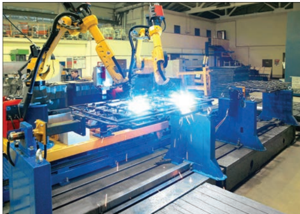
Роботизированный комплекс для сварки стенок контейнеров
