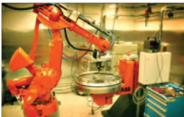
Рис. 6. Небольшая гибкая система. Интерфейс робот/корпус эффективно защищен от утечек, используя адаптируемое замыкание. Шкафы объемом до 27 м<sup>3</sup> были изготовлены для размещения больших систем
