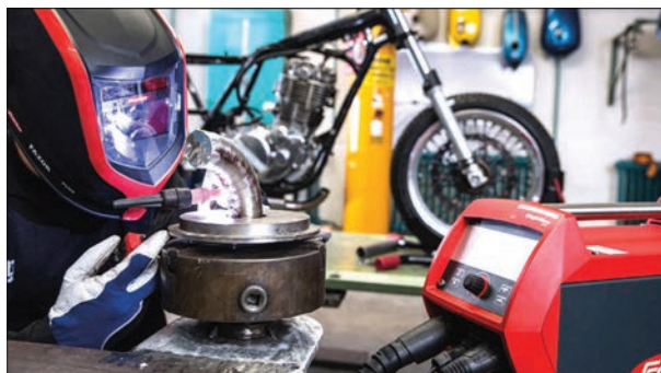
Источник питания MagicWave 230i может обмениваться данными с другими устройствами через интерфейсы Bluetooth, Wi-Fi и NFC
