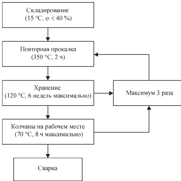
Рис. 1. Схема управления подготовкой к сварке и применением электродов с низководородным покрытием
