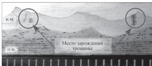
Рис. 8. Внешний вид боковой поверхности образца с участками, где зародились усталостные трещины: о.м. — основной металл; н.м. — наплавленный металл
