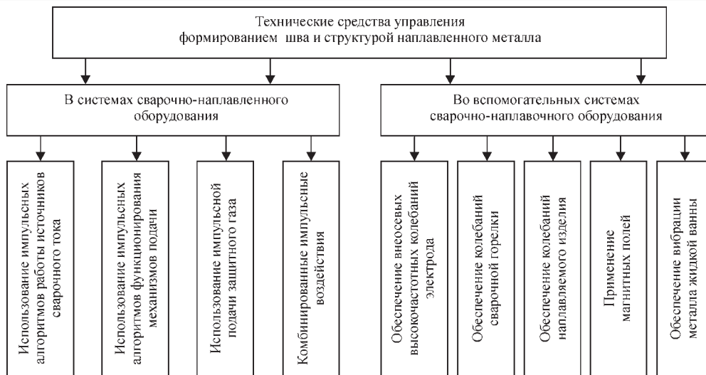
Рис. 1. Технические средства воздействия на свойства шва или наплавленного слоя
