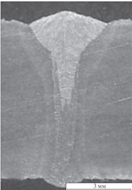
Рис. 3. Отсутствие однородного распределения металла электродной проволоки по глубине шва при лазер-MIG сварке сталей больших (свыше 8 мм) толщин на примере сварки сталей SSAB Domex 420MC (стандарт EN 10149-2) [8]
