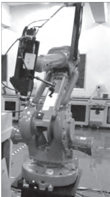
Рис. 7. Внешний вид роботизированного лабораторного стенда для лазерно-дуговой сварки с колебаниями фокуса лазерного излучения
