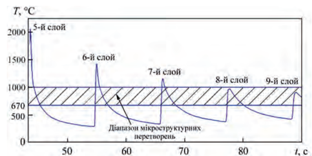
Рис. 7. Характерний термоцикл в матеріалі таврового зразка (5-й шар) при багатшаровому формуванні
