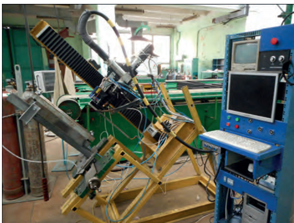
Рис. 1. Лабораторний стенд для лазерного зварювання в різних просторових положеннях
