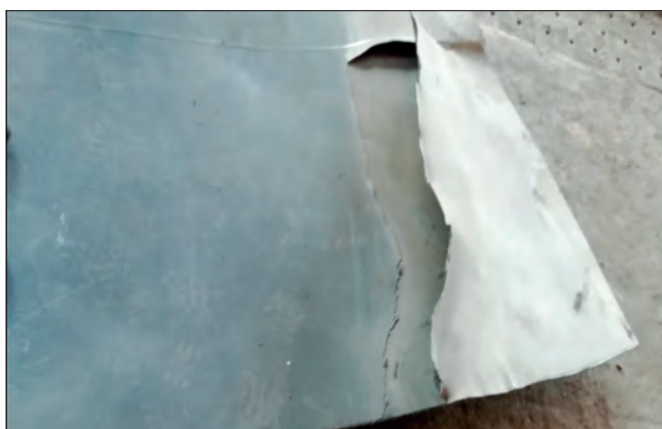
Дефекты при производстве биметалла титан-сталь
