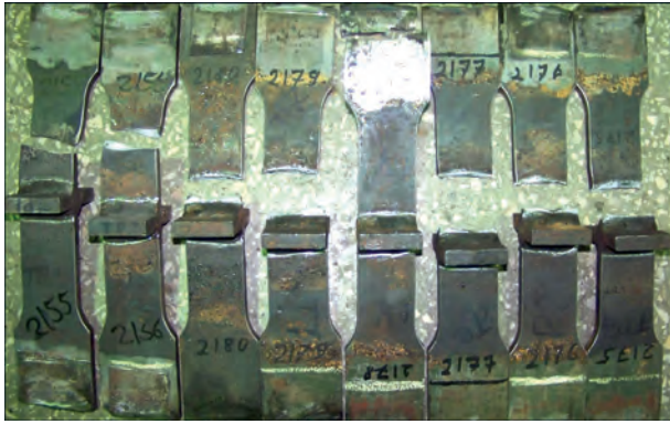
Рис. 4. Випробувані на втому зразки таврових зварних з'єднань сталі 15ХСНД з поверхневими втомними тріщинами, які зміцнювали ВМП після витримки у камері Г4 на протязі 1200 год.
