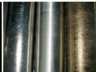
Поверхня зливків титану: оплавлена; механічно оброблена; лита
