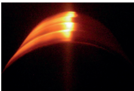
Процес оплавлення зливку титану діаметром 1100 мм
