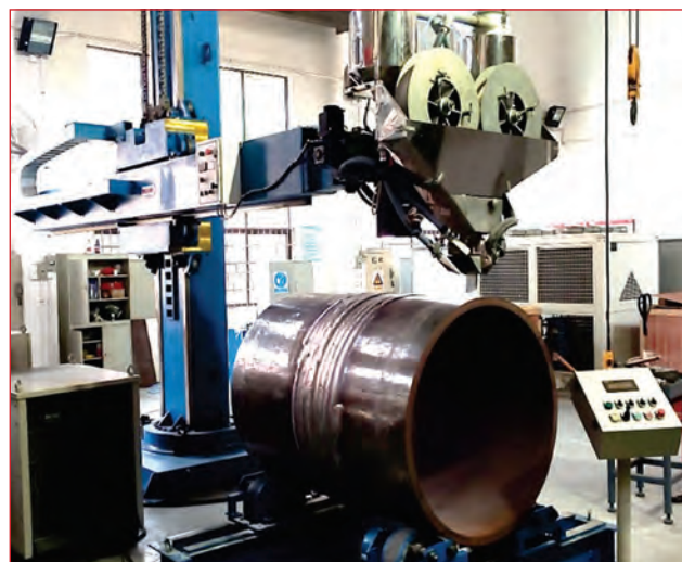
Електрошлакове наплавлення двома стрічками великогабаритних конструкцій енергетичного обладнання
