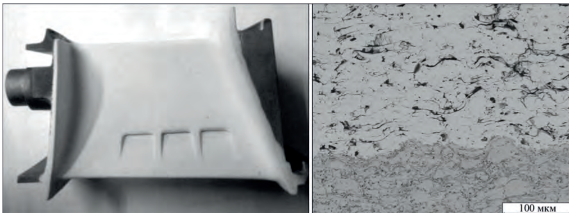
Рис. 5. Лопатка з теплозахисним покриттям, отриманим методами HVOF/APS та структура міжфазної межі металевого (HVOF) та керамічного (APS) прошарків системи ТЗП
