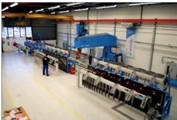
Рис. 3. Виробництво рулів висоти та рулів напрямку методом індукційного зварювання із ТПК вуглеволокна/PPS для реактивного літака Dassault Falcon 5X
