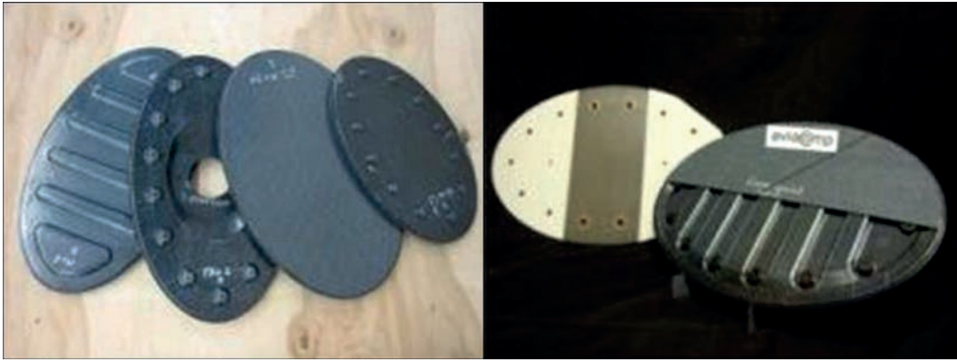
Рис. 4. Люки доступу паливного бака для вузьких літаків Airbus A220, виготовлені з ТПК компанією Aviascomp з використанням технології індукційного зварювання, розробленої компанією KVE Composites
