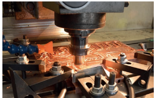
Сварка трением с перемешиванием радиатора из медного сплава
