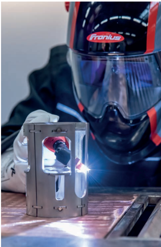
Такі додаткові можливості, як функція сенсорного високочастотного підпалювання і компактний зварювальний пальник (додаткова комплектація), спрощують зварювання компонентів у незручному розташуванні
