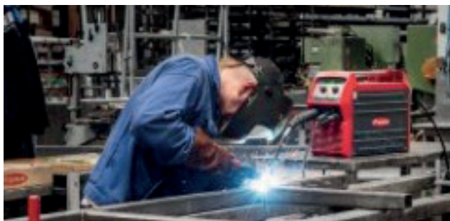
Окремі компоненти зварюють у готову сталеву дверну коробку
