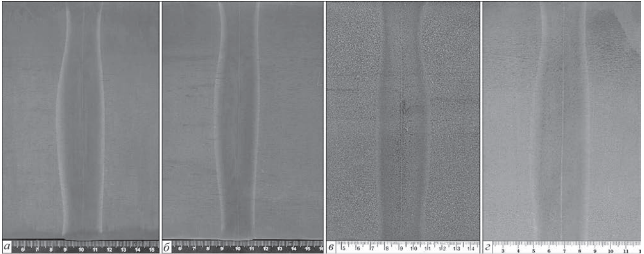
Рис. 4. Макрошліфи рейок різних марок сталей при зварюванні пульсуючим оплавленням на оптимальних режимах: а – R350HT (ЗТВ – 28 мм); б – K76Ф (ЗТВ – 27 мм); в – R260 (ЗТВ – 31 мм); г – M76 (ЗТВ – 37 мм)
