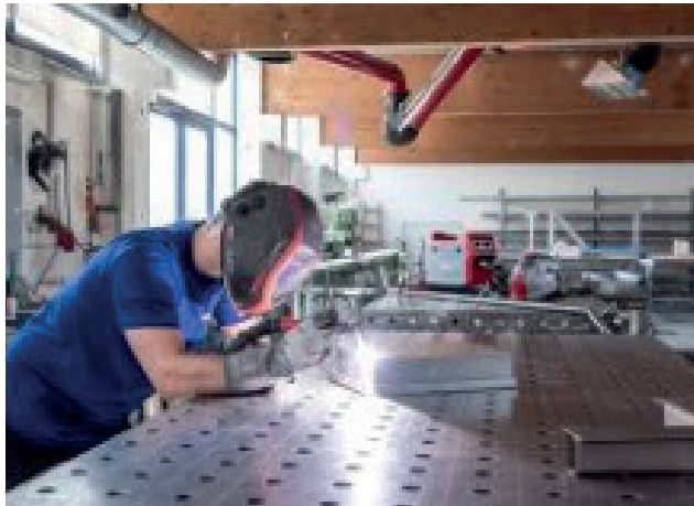
Зварювання алюмінієвих конструкцій
