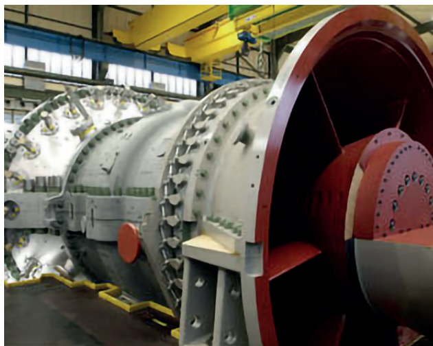
Загальний вигляд газової турбіни Siemens SGT5-4000F
