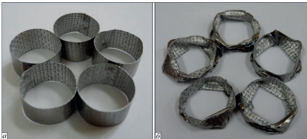
Рис. 5. Загальний вигляд циліндричних зразків до (а) і після (б) випробувань на стиснення
