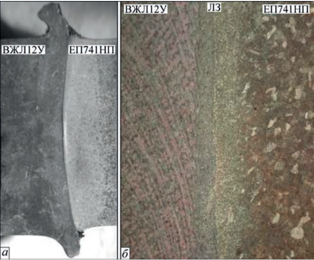
Рис. 7. Макрошліф ( \times 100 ) (а) та мікроструктура (б) з'єднання сплавів ВЖЛ12У та ЕП741НП
