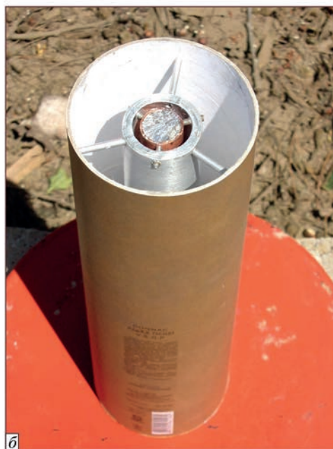
Рис. 1. Схема збірки під зварювання вибухом для отримання біметалічної трубною заготовки (а) та заготовки під зварювання вибухом зі сталевим стрижнем, залитим сплавом Вуда всередині мідної трубки (б)
