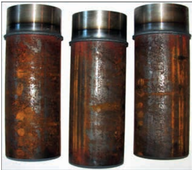
Рис. 2. Зварне з'єднання трубчастих деталей 102×6 мм зварювальної дуги, яке виникає під час початку процесу і складає величину в межах 20...30 В постійного струму, нормується до вихідної напруги 2...3 В. Для подальшої обробки та аналізу похідний сигнал падіння зварювальної напруги з виходу підсилювача 8 надсилається на вхід аналого-цифрового перетворювача (АЦП). Під час початку роботи програмного забезпечення АЦП налаштовується таким чином, що частота опитування аналогових входів складає 10 точок опитування на одне читання даних з виходу АЦП. Досягається більш точне передавання даних до програми контролю.
