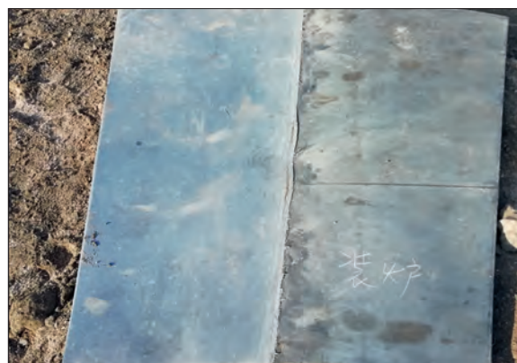
Внешний вид биметалла после восстановления
