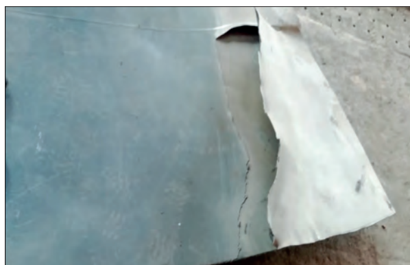
Дефекты при производстве биметалла титан-сталь
