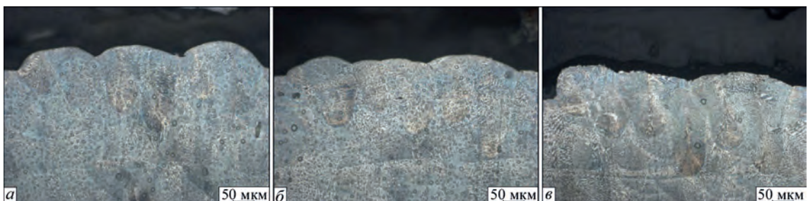
Рис. 5. Микроструктура єдиного слоя при мощності лазера 170 Вт і швидкості сканування: а – 900 мм/с ( E = 38 Дж/мм 3 ); б – 850 мм/с ( E = 40 Дж/мм 3 ); в – 700 мм/с ( E = 48 Дж/мм 3 )
