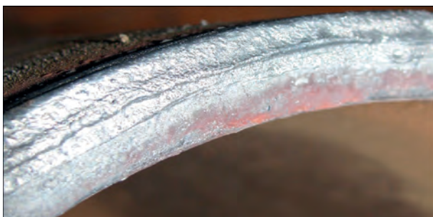
Рис. 2. Сліди, залишені зварювальною дугою при нагріванні зовнішніх кромek труби
