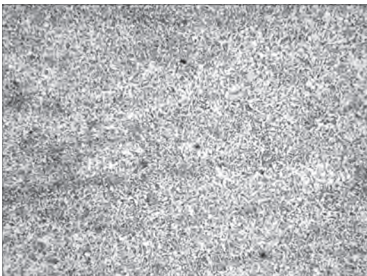
Рис. 13. Мікроструктура ( \times 200 ) ділянки повної і неповної перекристалізації з боку труби
