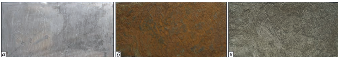
Рис. 4. Зовнішній вигляд поверхні зразка наплавленого шару на основі сталі 30X: а – у вихідному стані; б – з продуктами корозії; в – після видалення продуктів корозії
