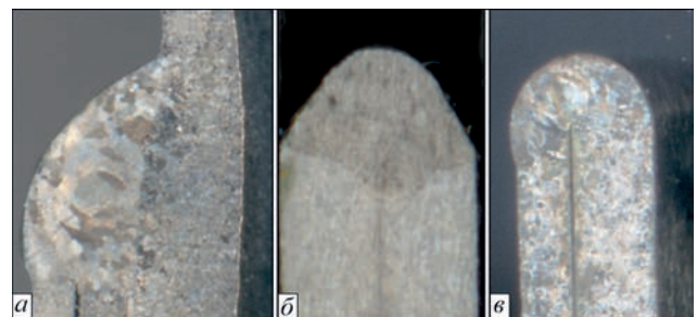
Рис. 3. Макрошліфи характерних типів зварних з'єднань катодного вузла (КВ): а-в – відповідно шви № 1, № 5, № 6
