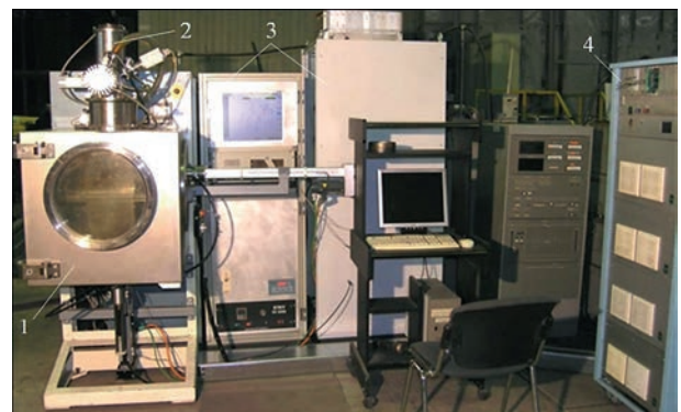
Рис. 2. Устаткування для електронно-променевого 3D друку (опис 1–4 див. у тексті)
