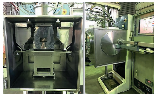
Рис. 3. Вакуумна камера адитивного устаткування
