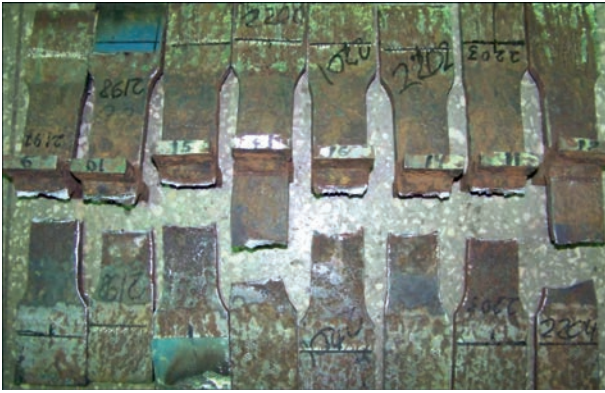
Рис. 5. Випробувані на втому зразки таврових зварних з'єднань сталі 15XCHD з поверхневими втомними тріщинами, які зміцнювали ВМП після витримки у камері КСТ-1 на протязі 1200 год
