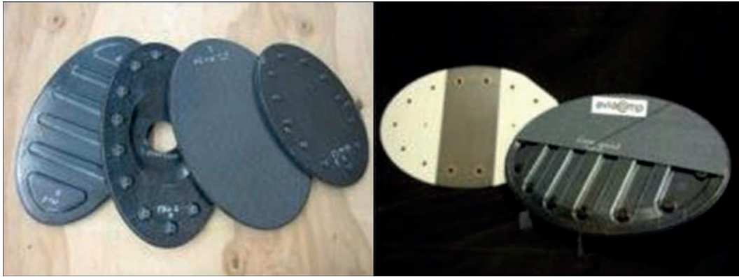
Рис. 4. Люки доступу паливного бака для вузьких літаків Airbus A220, виготовлені з ТПК компанією Aviascomp з використанням технології індукційного зварювання, розробленої компанією KVE Composites
