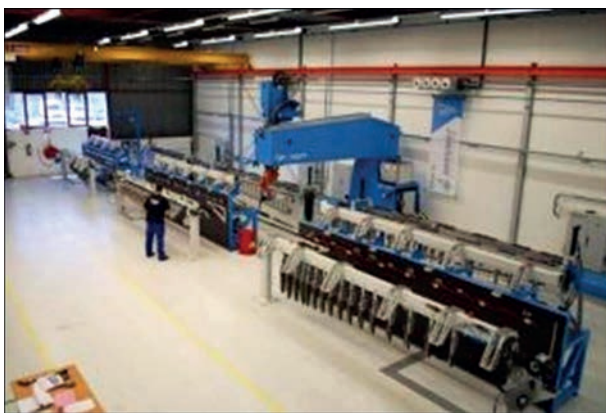
Рис. 3. Виробництво рулів висоти та рулів напрямку методом індукційного зварювання із ТПК вуглеволокно/PPS для реактивного літака Dassault Falcon 5X
