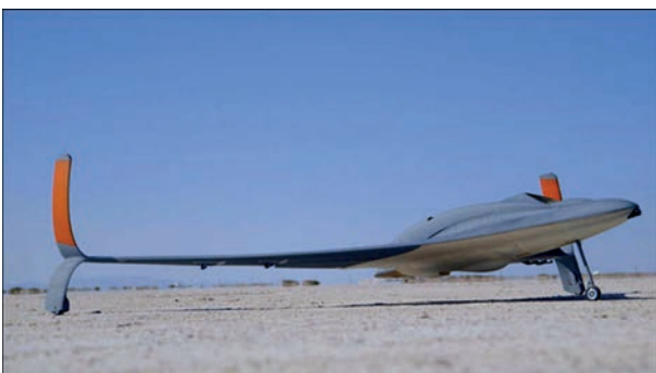
Рис. 9. БПЛА на 80 % 3D надрукований з полімерних матеріалів
