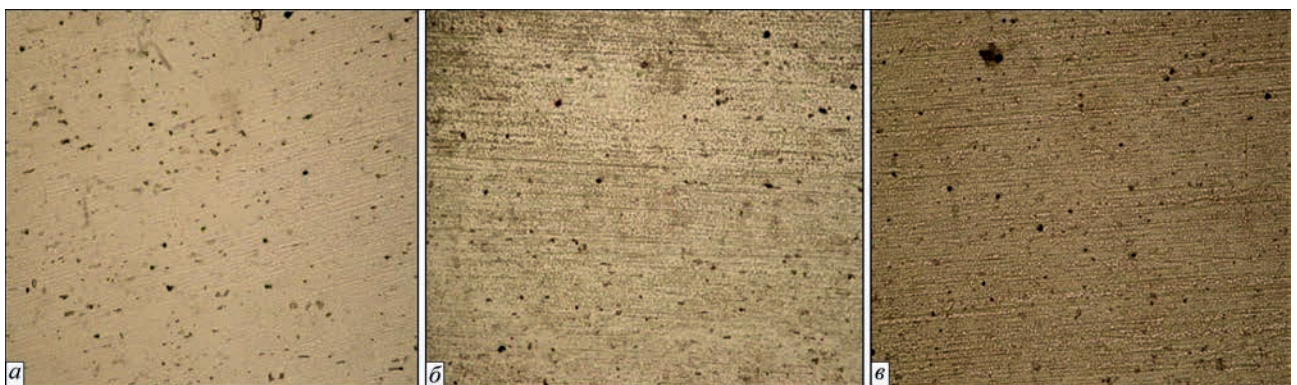
Рис. 1. Мікроструктура ( \times 320 ) основного металу сплаву В1341 у стані гартування та природного старіння (а), після штучного старіння (б) та після повної термічної обробки (гартування та штучного старіння) (в)
