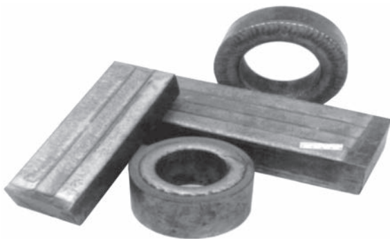
Рис. 3. Деталі запірної арматури, наплавлені плазмовим методом порошком ПР-08X17H35C3P
