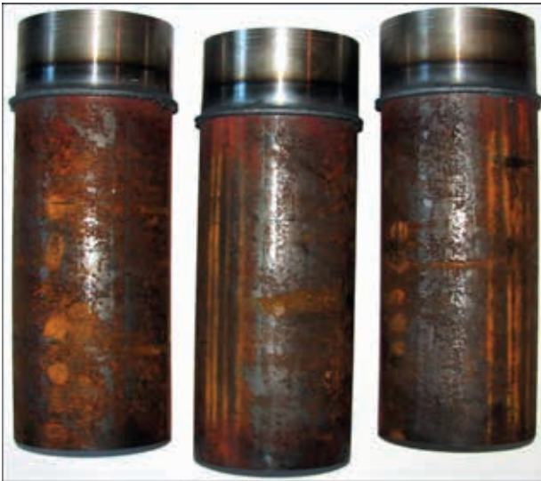
Рис. 2. Зварне з'єднання трубчастих деталей 102×6 мм
