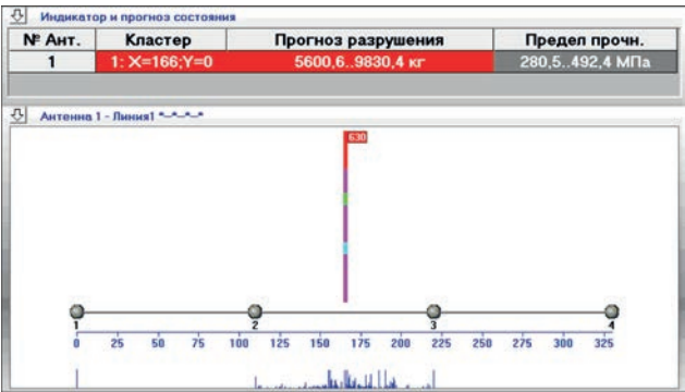
Рис. 23. Екран програми ЕМА-3.92 після випробування типового зразка сталі 20 з пошкодженої труби
