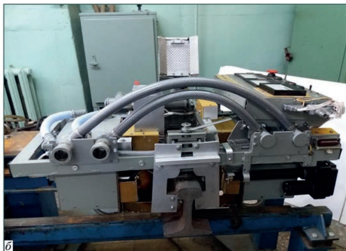
Рис. 1. Переносний модуль для термічної обробки зварних стиків залізничних рейок: схема конструкції (а) та загальний вигляд (б) (опис 1–10 див. у тексті)
