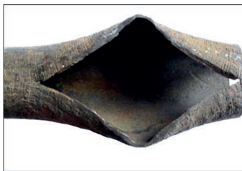
Рис. 1. Руйнування паропроводу зі сталі 12X1МФ по механізму повзучості. Ресурс 276 тис. год.
