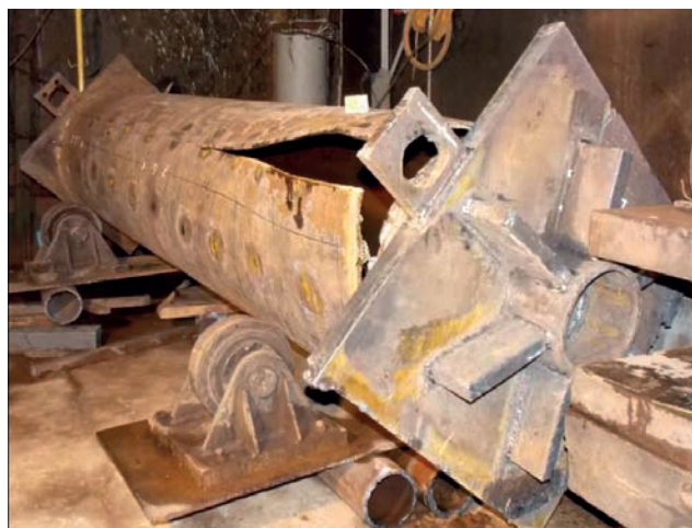
Рис. 4. Загальний вигляд місця руйнування контрольного зразка труби після гідравлічного навантаження тиском 13,25 МПа
