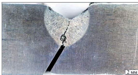
Рис. 2. Поперечний перетин шва, звареного під водою [11]
