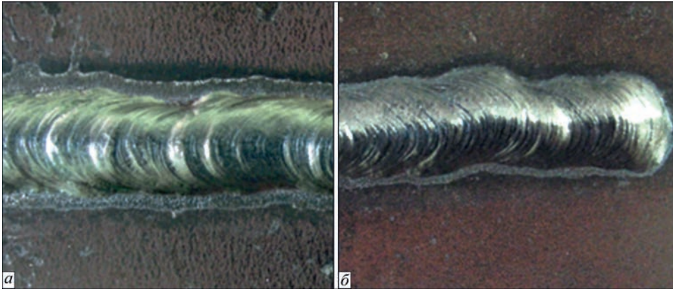
Рис. 6. Результати експериментального дослідження постового перетворювача з переносом заряду: а – 10; б – 100 Гц
