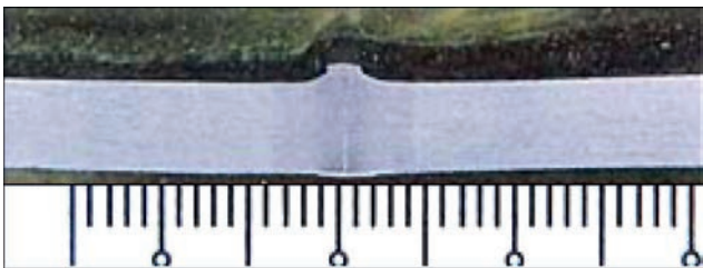
Рис. 9. Макрошліф зварного з'єднання
