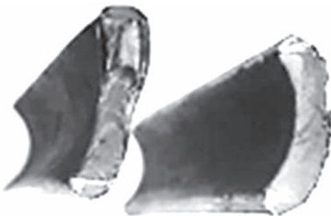
Рис. 7. Випробування на злом зварного зразка труби
