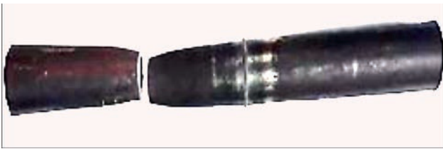
Рис. 5. Випробування зварного зразка труби на розрив
