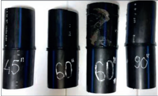
Рис. 3. Зварні з’єднання, що використовувалися для візуального огляду
