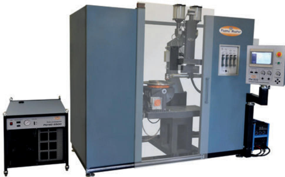
Рис. 2. Установка для плазмово-порошкового наплавлення РМ-302
