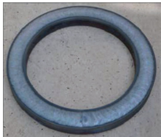
Рис. 4. Щілинне кільце, напавлене плазмово-порошковим методом
