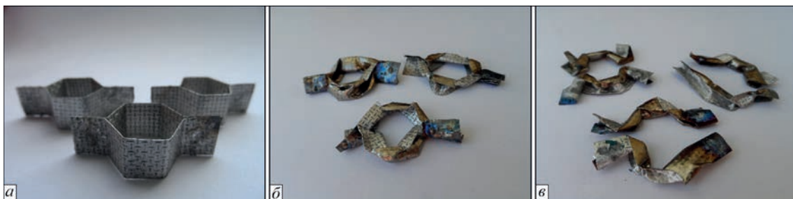
Рис. 4. Загальний вигляд зразків одиничних стільників до механічних випробувань на стискання (а) та після (б, в)
