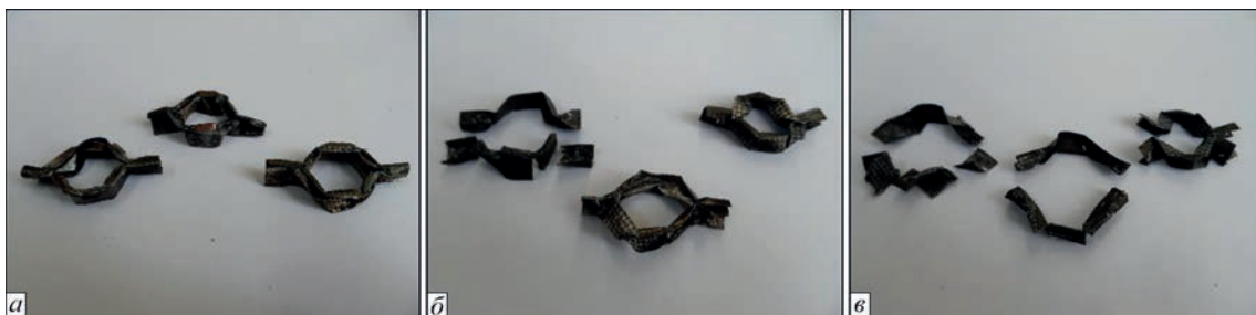
Рис. 7. Загальний вигляд зразків одиничних стільників після відпалу та механічних випробувань на стиснення, T_{\text{відп.}} , °C; t_{\text{відп.}} , хв: а – 600, 150; б – 600, 600; в – 600, 1200
