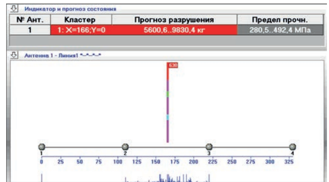
Рис. 23. Екран програми ЕМА-3.92 після випробування типового зразка сталі 20 з пошкодженої труби
