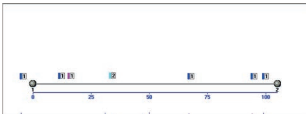
Рис. 7. Знімок екрану локації системи ЕМА (дані на наступний день після зварювання (13ХГМРБ))
