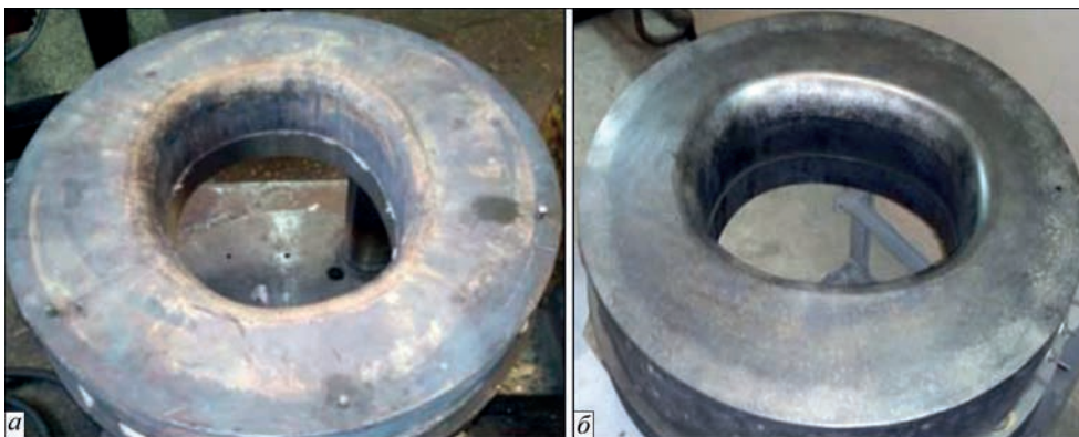
Рис. 6. Поверхня штампа для глибокої витяжки виробів з листа титану VT-6: а – немодифікована; б – модифікована імпульсною плазмою з комплексним легуванням вуглецем, вольфрамом і киснем
