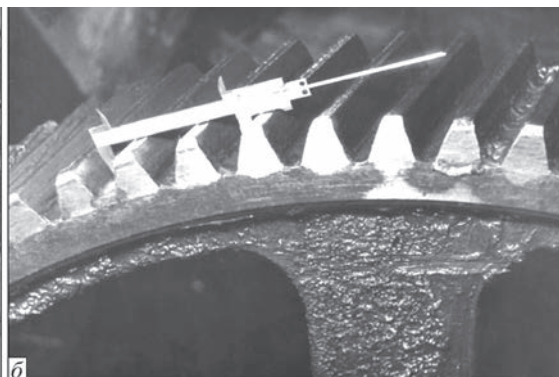
Рис. 8. Зовнішній вид відновленого зубчастого колеса після термічної обробки (а) і встановленого в привід обертання окорувального барабана (рис. 8, б) після механічної обробки наплавлених зубів (б)
