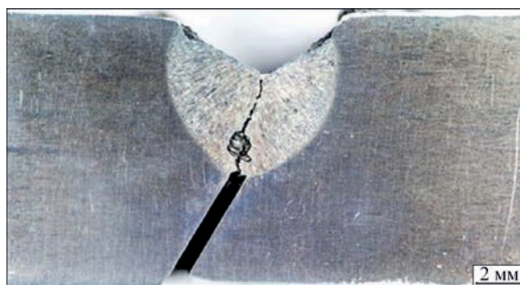
Рис. 2. Поперечний перетин шва, звареного під водою [11]
