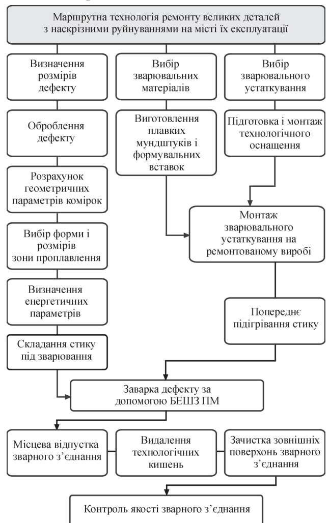
Рис. 2. Алгоритм прийняття рішень при ремонті наскрізних тріщин у великих сталевих деталях агрегатів на місці їх експлуатації
