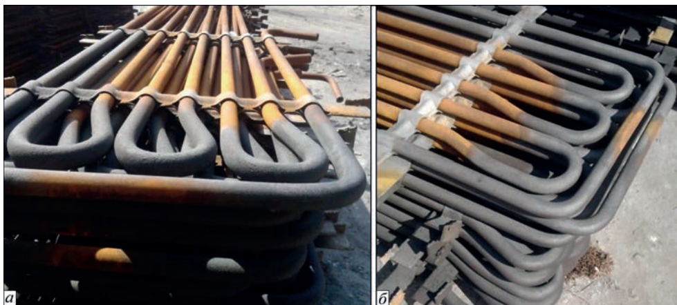
Рис. 6. Зовнішній вигляд напилених змійовиків
