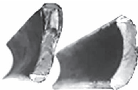
Рис. 7. Випробування на злом зварного зразка труби
