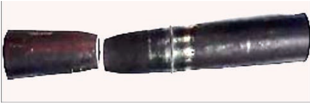
Рис. 5. Випробування зварного зразка труби на розрив
