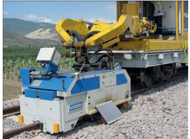
Рис. 5. Контейнерна система зварювання рейок Multiflex зі зварювальною головкою AMS60
