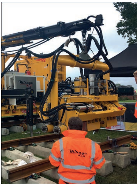
Рис. 10. Індукційний зварювальний робот фірми Mirage Rail електронної вимірювальної системи. Струмопідведення повністю незалежно від затискання і здійснюється по зовнішній стороні головки рейок і їх ніжки. Маса та габарити машини AMS200 не перевищує масу машини AMS60.
