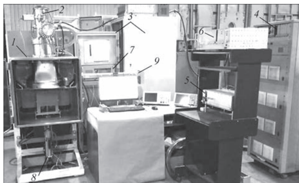
Рис. 3. Устаткування для електронно-променевого 3D-друку (позначення 1–9 див. у тексті)
