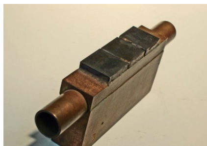
Модель дивертора Cu – W
