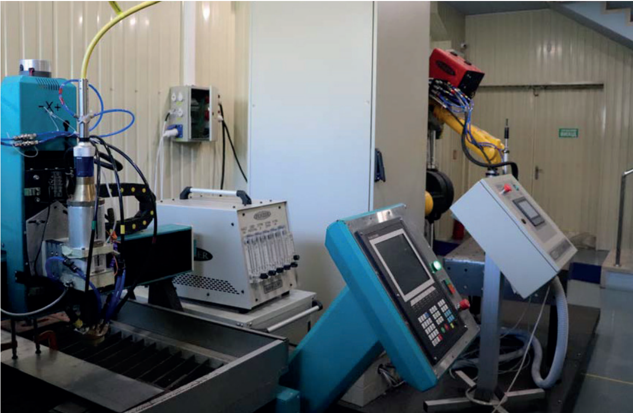
Рис. 8. Універсальний технологічний комплекс лазерного та гібридного лазерно-плазмового різання
