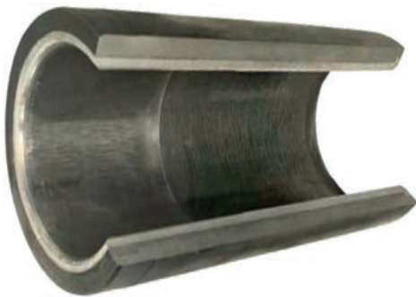
Рис. 6. Зовнішній вигляд наплавленої втулки діаметром 160 мм
