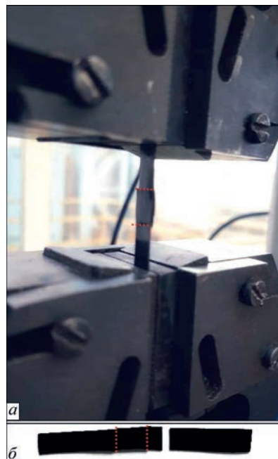
Рис. 2. Зовнішній вигляд напускного зварного з'єднання полі(ДГЕБА/ТЗМ)/ГО плівок в процесі проведення випробувань на розтяг (а) та після руйнування (б)
