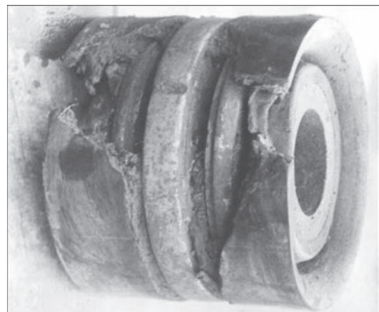
Рис. 8. Зовнішній вигляд поршня з гумовими манжетами після досліджень втулки, яку наплавлено порошком сплаву H75X15C4P4
