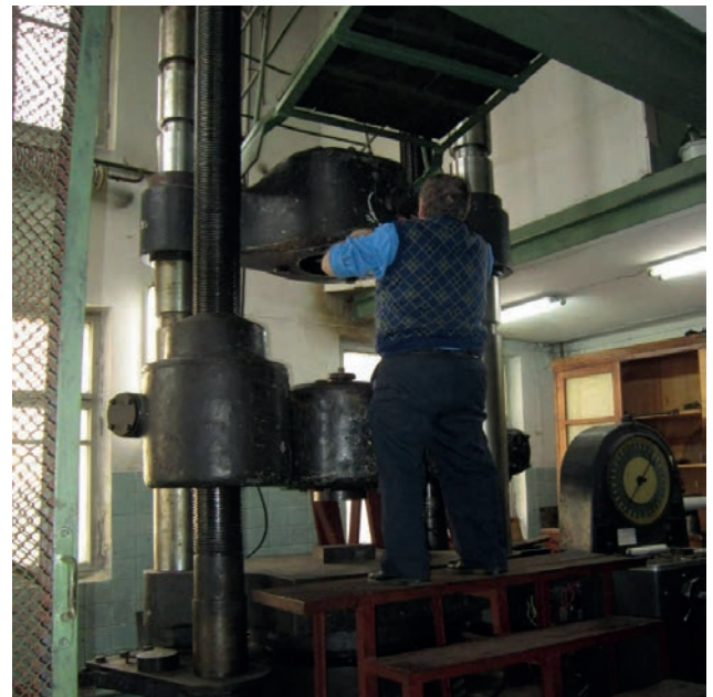
Рис. 6. Розривна машина «Baldwin 300»
