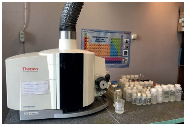
Рис. 2. Оптичний емісійний спектрометр з індуктивно-зв'язаною плазмою iCAP 6500 DUO
