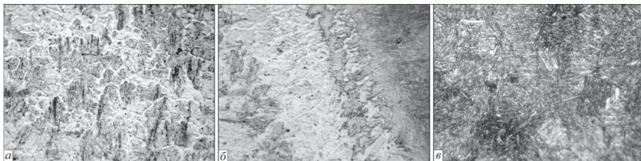
Рис. 3. Мікроструктура ( \times 500 ) з'єднання сталі 30X2H2MДФ при ІДЗ на форсованому режимі: a – шов; б – лінія сплавлення; в – ділянка крупного зерна ЗТВ
