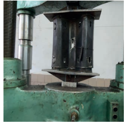
Рис. 5. Випробування на розрив дорожнього бар'єрного огородження
