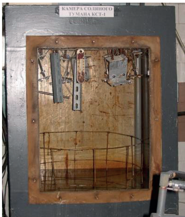
Рис. 7. Камера соляного туману КСТ-1
