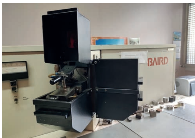
Рис. 1. Оптичний емісійний спектрометр Baird SPECTROVAC-1000
