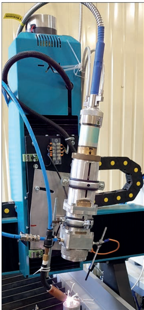
Рис. 7. Лабораторний стенд для проведення експериментів з лазерного приварювання фланців герметичними швами з не-наскрізним проплавленням тонкостінного циліндричного ви-робу з алюмінієвого сплаву
