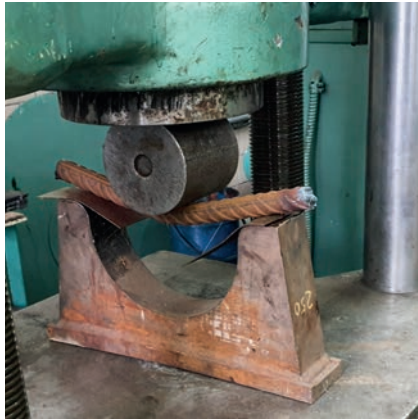
Рис. 4. Випробування арматури діаметром 25 мм на загин
