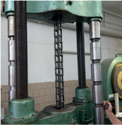
Рис. 3. Випробування ланцюга на розтяг на 100 тн розривній машині
