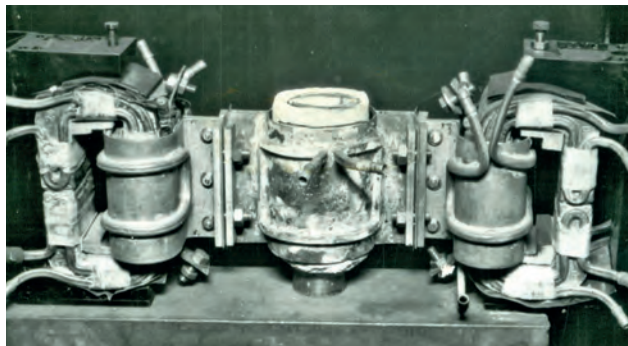
Рис. 13. Двохтрансформаторна компактна індукційна піч для тигельного переплаву металу
