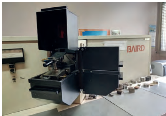
SPECTROVAC-1000 DV-4 (BAIRD, Нідерланди). Оптичний емісійний спектрометр дозволяє проводити аналізи хімічного складу проб сплавів на залізній, нікелевій, алюмінієвій, мідній, титановій основах, а також чистої міді
