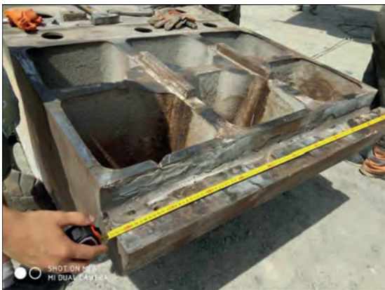
Рис. 1. Конструктивні особливості корпусу шатуна
