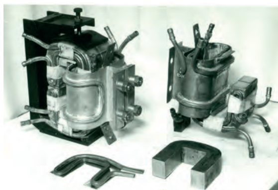
Рис. 12. Зовнішній вигляд і елементи трансформатора для індукційного нагріву
