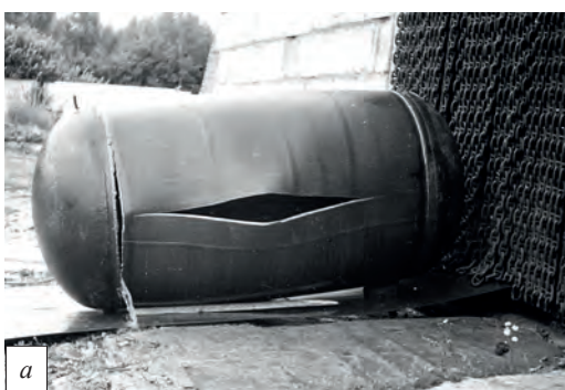
Рис. 8. Натурні випробування криволінійних труб класу Х70: а – ділянка труби діаметром 1420 мм (з привареними заглушками), отриманими за технологією ЕТЗ, після натурних гідравлічних випробувань; б – криволінійна ділянка труби вилучається з укриття безпосередньо після руйнування під час гідравлічних випробувань
